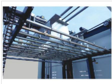
工业翻转机能适应不同规格的货物的翻转要求，安全、平稳、有效地提供工艺输送，实现将货物由卧式转换成立式或将立式转换成卧式的作业目标。普遍应用于冶金、冲压、钣金、模具、造纸、冷藏、钢带、线盘、桶料、卷料等行业。工业翻转机包括由翻转铰链连接的底座和翻转体，翻转机通过翻转铰链和底座进行连接，在翻转机的中部设有胶辊，胶轮架与底座形成连接，方便快捷地将货物进行任意角度的翻转，或者附加到输送线，采用多段速控制，和行程开关，将货物翻转任一角度后移动到下道流水线；实现货物输送的立体流程，无需人工和行吊等高输送率特点，翻转机结构简单、造价低、工作效率高、安全可靠。集装箱翻转机：可以迅速合理的开展运输海运集装箱。天津纸张翻转机售价
