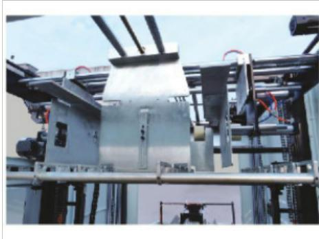
翻转机的原理翻转机包含由旋转铰链连接的基座和旋转体, 翻转机根据旋转门铰链和基座开展联接, 在翻转机的中南部下设胶棍, 胶轮架与基座产生联接, 省时省力地将货品开展随意视角的旋转, 或是额外到输送机, 选用多段速操纵, 和限位开关, 将货品旋转任意视角后中移动到下道生产流水线; 保持货品运输的立体式步骤, 不用人工服务和行吊差不多高运输率特性, 翻转机构造简易、工程造价低、工作效能高、可以信赖。如今市面有各种各样翻转机, 可是愿意寻找这款合适自身的翻转机, 却并不是那麼非常容易。天津纸张翻转机售价链式翻转机设备操作规程: 工作前需穿戴好防护用品, 如安全帽。
